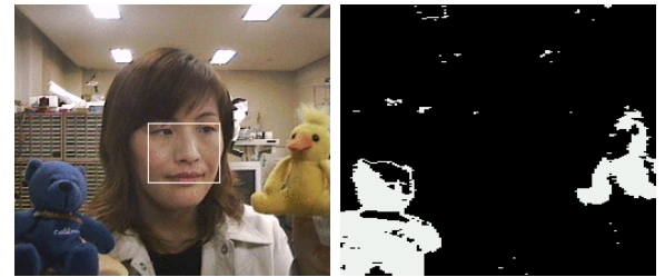
(b) ロボットの左カメラ画像 (左図: テンプレートマッチング法による養育者の顔検出結果, 右図: YUV 空間での閾値処理による色抽出結果)
